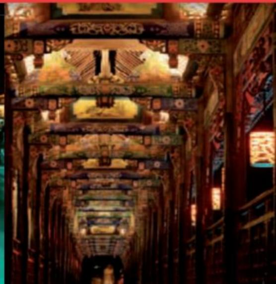
Tous les éclairages sont dirigés vers le bas. Les éclairages des toitures des ponts couverts, réalisés en contre-plongée, sont cadrés très précisément sur les poutres de rive afin de ne créer aucune nuisance lumineuse vers les immeubles riverains et de limiter la pollution céleste. L'éclairage intérieur des ponts couverts importe car ces espaces publics de rencontre sont très appréciés la nuit par la population locale et les visiteurs.
